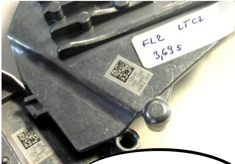
Hořčíkové slitiny jsou jedním z nejlehčích materiálů používaných v automobilovém průmyslu. Laserové značení je velmi kontrastní a proto je datamatrix kód dobře čitelný.
