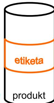
Následuje aplikování etikety, která plynule vyjízdí z aplikační plošky. Díky rotačnímu pohybu produktu se etiketa navíjí, respektive aplikuje po celém obvodu.
