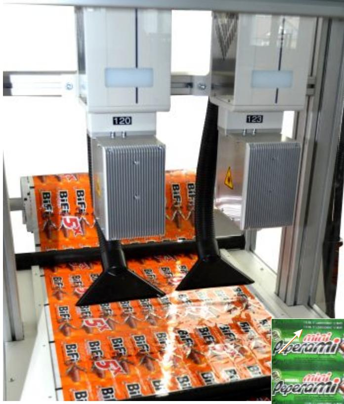
*Solaris laser značí na obalové folie potravin, jako jsou čokoládové tyčinky Mars, Snickers a taky na masové svačinky BiFi. Je zde kladen důraz na estetiku značení a úsporu ceny za značení.*
