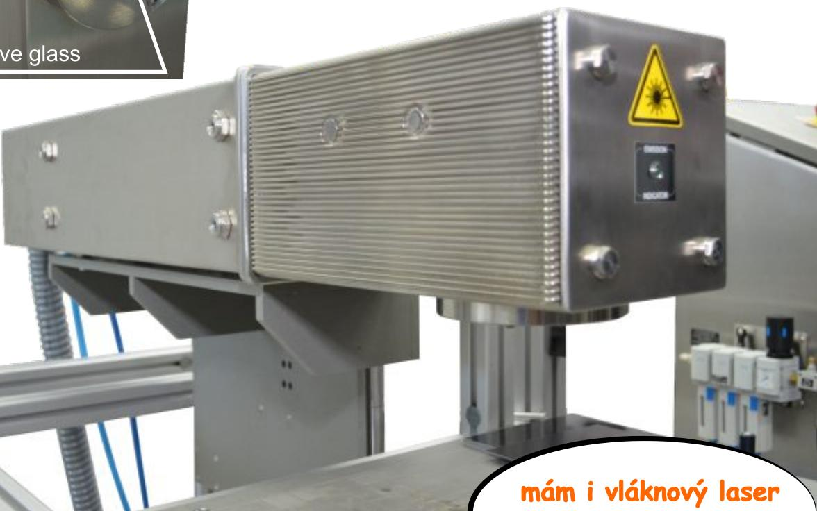
Inovace HD laserů spočívá i v použití ušlechtilých kovů, jako je nerez a to i na pasivní chlazení skenovací hlavy, kdy hliníkový chladič byl nahrazen nerezovým.
