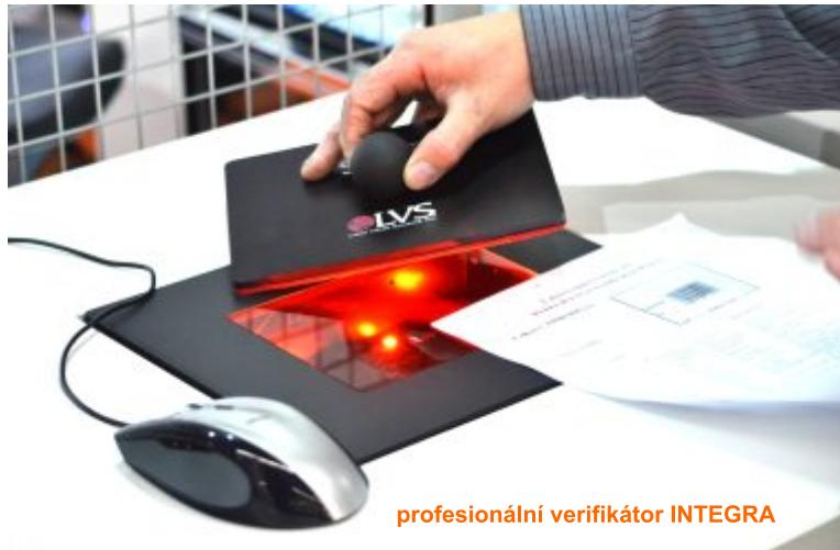
Pro zabezpečení správné produkce bez chyb v čárových a datamatrix kódech jsou zde pro kontrolu speciální verifikátory. Nejen že přečtou kód, ale rozeberou jej do nejmenších detailů a zjistí jeho nedostatky.
