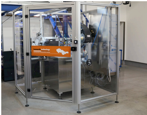
Krytování zadní části pracovní stanice se servisními dveřmi
