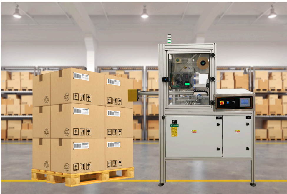
Na zakázku vytvořený paletový aplikátor PA v Leonardo technology s.r.o. s tiskárnou NOVEXX XPA 936, který dokáže aplikovat etikety na dvě strany palety na jedno zastavení palety.
