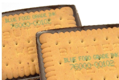
Ukázky značení inkjet tiskárnou Leibinger JET2neo
