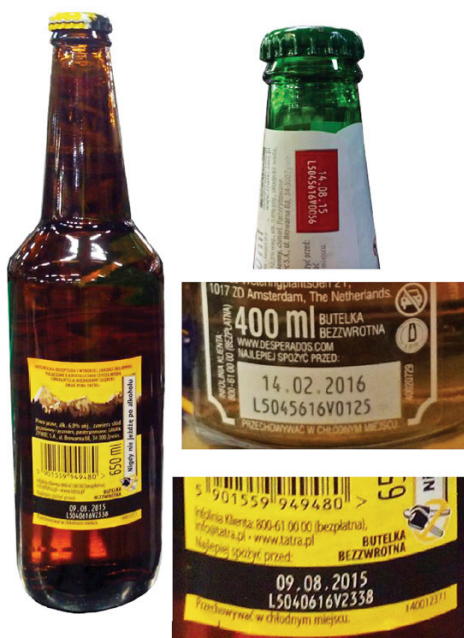
Ukázka značení laserem Solaris do etikety na stáček lince
