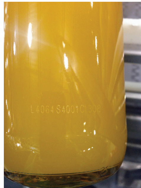
Ukázka značení laserem Solaris do skla na stáček lince
