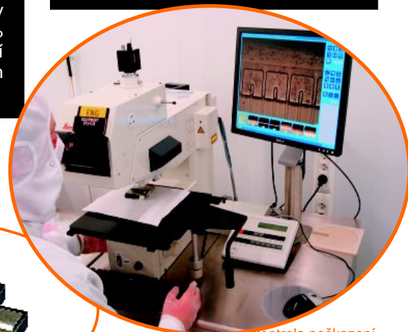
Kontrola poškození termotransferových tiskových hlav pod mikroskopem
