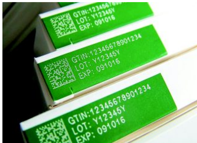
výsledek značení CO 2 laserem Solaris na krabičce od léku v produkci 400ks/min
