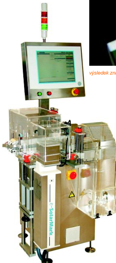
laserové značení pro farmaceutický průmysl s automatickou verifikací kódu
