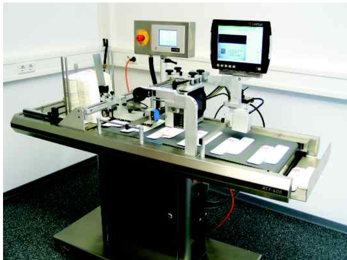
podavač kartonových krabiček s tiskárnou a s verifikátorem Laetus
