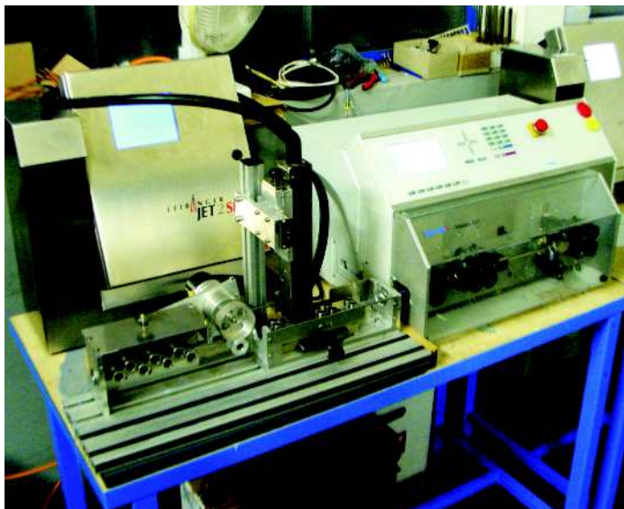
Ukázka pracoviště stříhače kabelu a tiskárny Leibinger JET2
