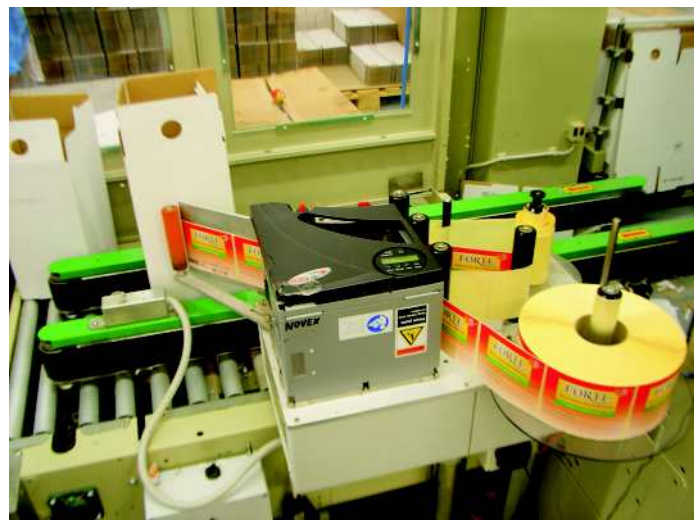
Aplikátor etiket s tiskárnou na dopravníku, který je součástí lepičky kartonu
