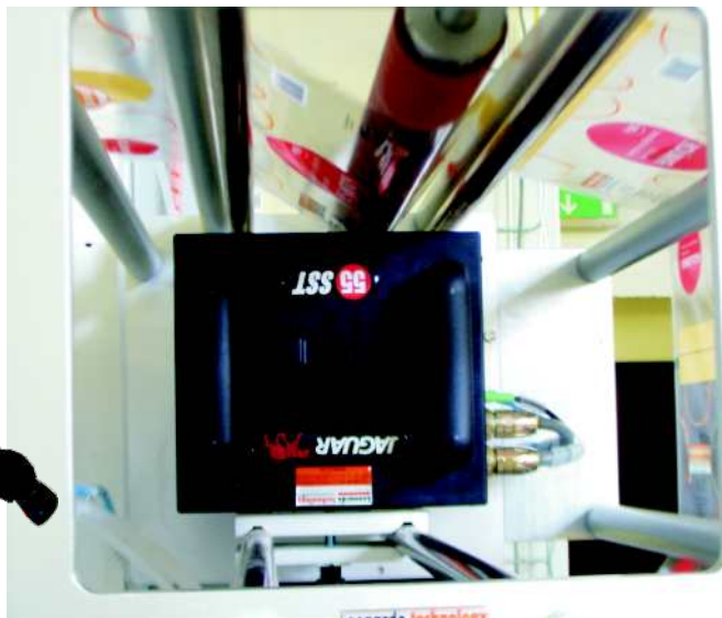
Detail instalace tiskárny do kontinuální balicí linky
