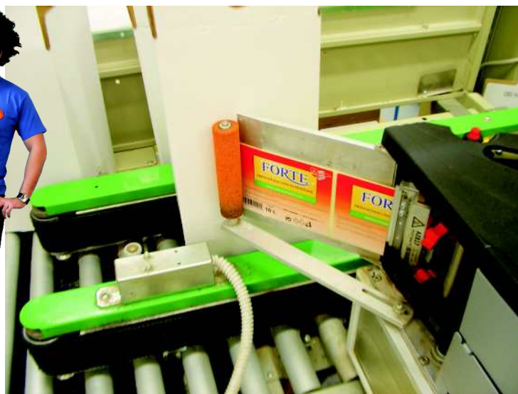
Detail na aplikační plošku a tiskový modul Avery Dennison
