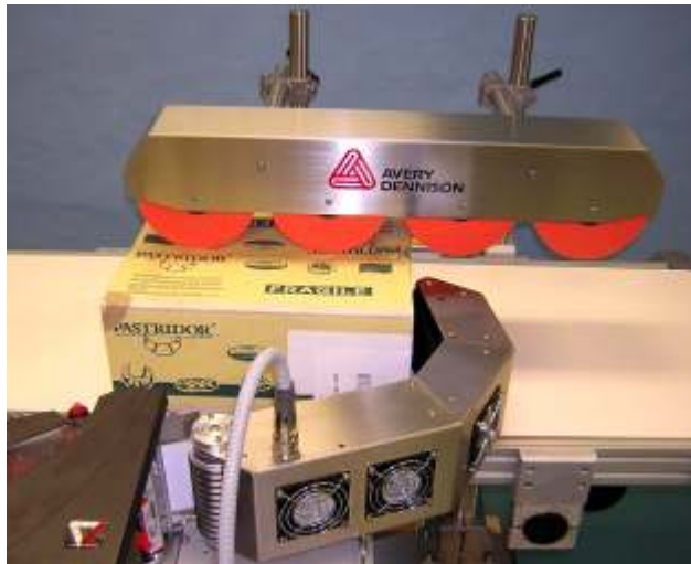
Detail aplikace etikety přes roh kartonu
