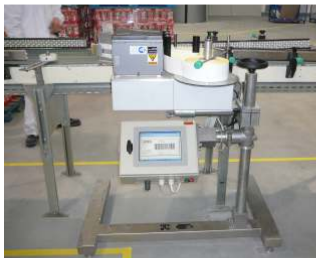
Aplikátor etiket na stojanu a s průmyslovým ovládacím terminálem
