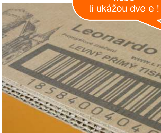
Detail potisku tiskárnou ALE na kartonový obalový materiál
