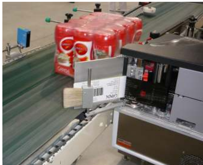
Detail aplikování etikety ihned po vytištění
