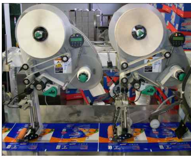
Umístění dvojčat Avery v lince zabezpečí 100% etiketování
