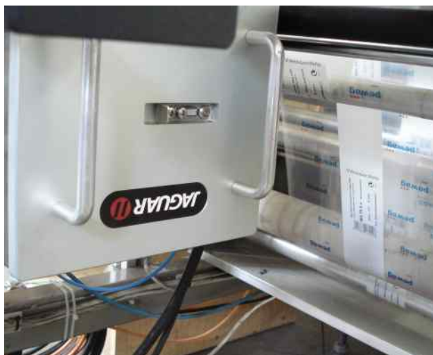
Umístění tiskárny v balící lince s vahadlem a akumulací částí
