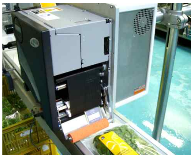
Pohled na tiskárnu Avery s etiketou těsně před jejím aplikováním
