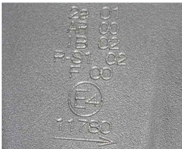
Detail značení laserem do plastu zadního světla automobilu
