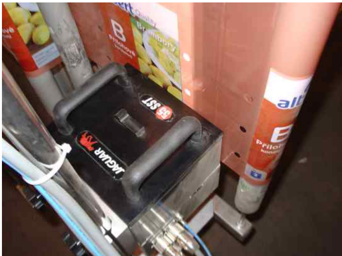
umístění tiskové části Jaguar 55sst v balící lince pro značení obalů
