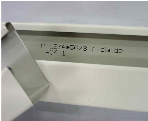
Detail potisku hliníkových profilů
