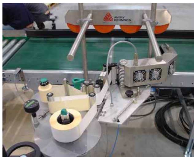
Aplikátor etiket s přidavným zařízením pro lepením přes roh krabice
