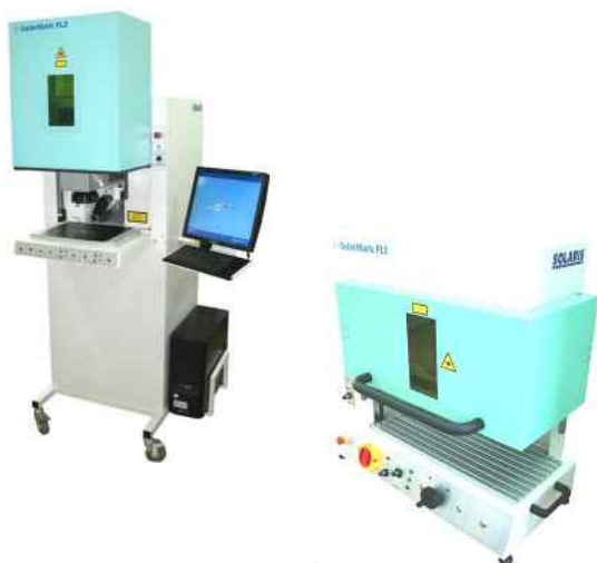
Pracovní stanice na značení předmětů s ručním provozem
