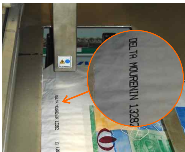
Detail potisku inkjetem za pohybu na nerovný povrch
