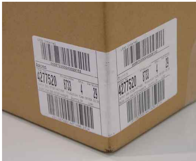
Detail etikety nalepené přes roh krabice s přesností aplikování +/- 1mm
