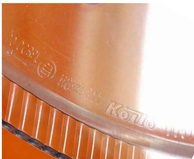
Ukázka značení na výšku 4mm
