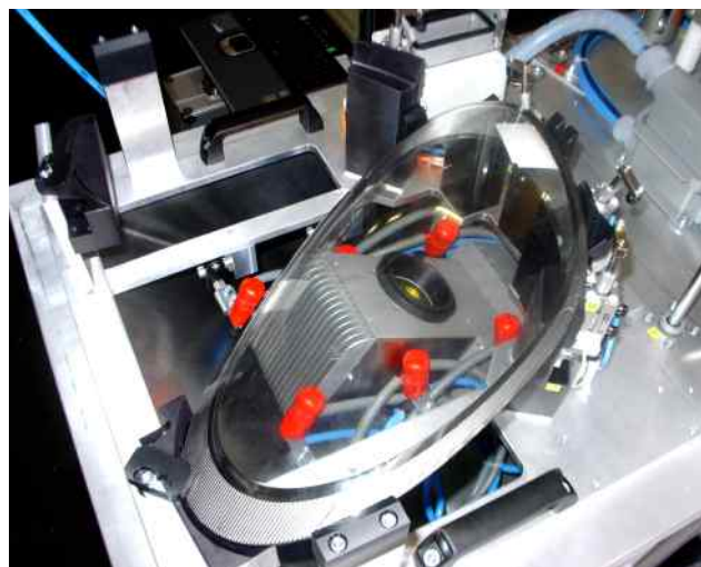
Značící hlava zakomponovaná do ručního pracoviště
