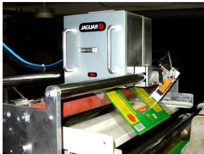
uchycení tiskárny v balicí lince
