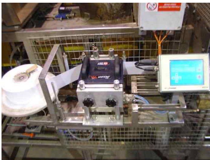
držák tiskárny pro potisk Granoten pásů
