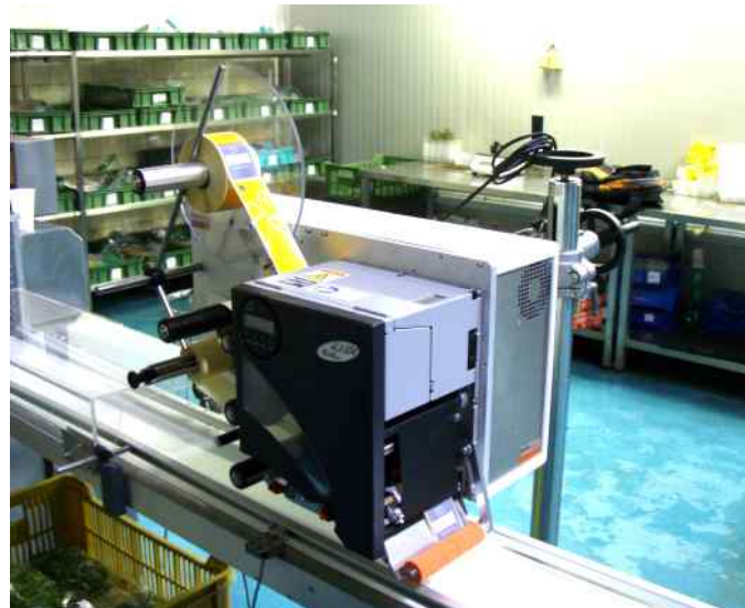
Celkový pohled na aplikátor etiket s tiskárnou Avery
