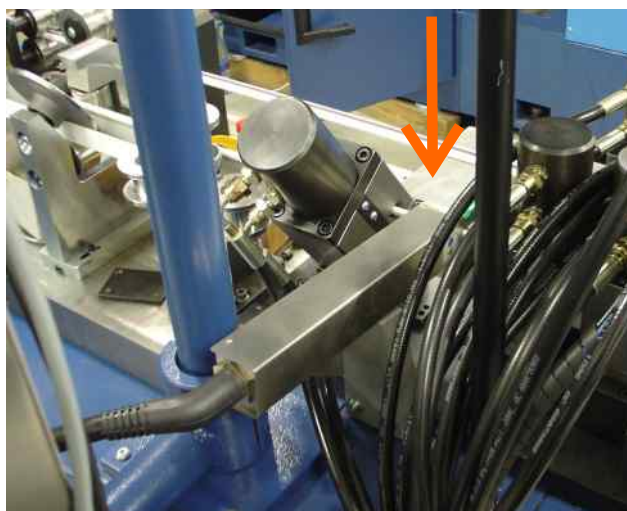
Tisková hlava v stísněném prostoru ohýbacího automatu
