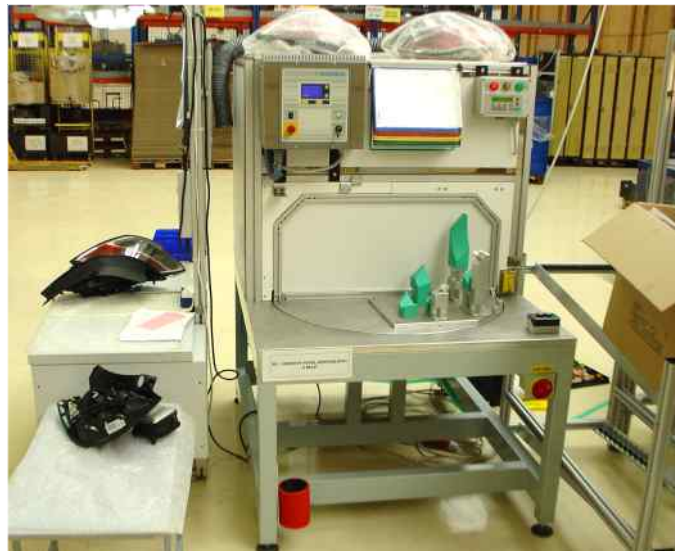
Laserové pracoviště s rotačním stolem pro dvě polohy
