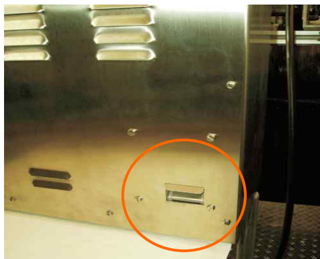
Zadní kryt ink jet systému s úpravou pro ECOSolv systém
