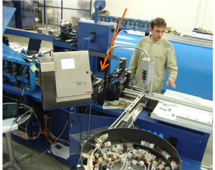
Umístění tiskárny v blízkosti výrobního procesu
