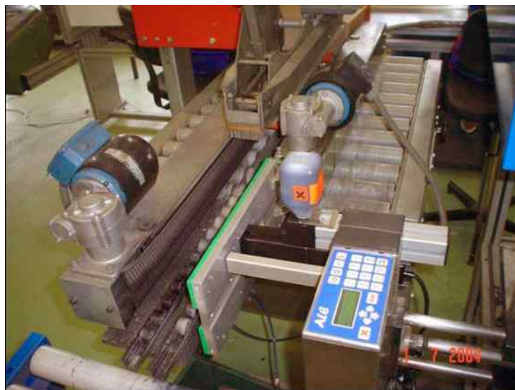
Tisková hlava ET2 s tiskem až 34 mm
