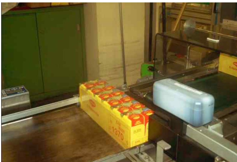
Tisková hlava ET7 s tiskem až 70 mm
