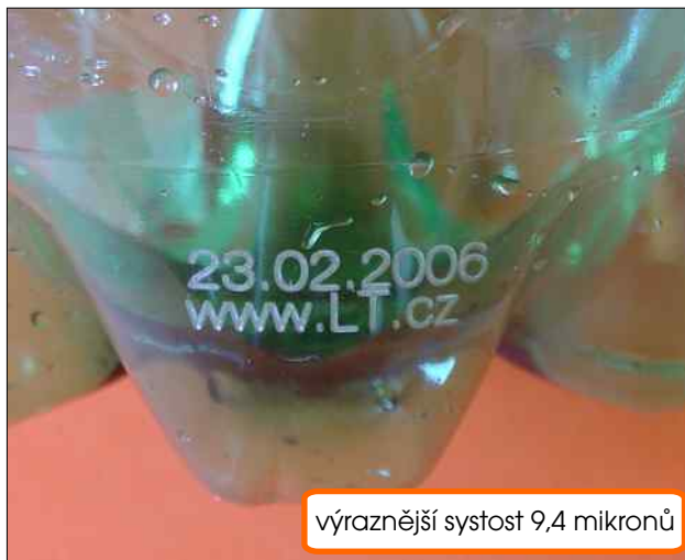
Absorbce infračerveného laserového spektra v polyamidu tloušťky 5,3um
