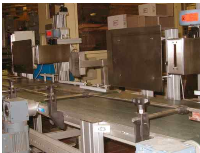
Tisková hlava ET7 s tiskem až 70 mm
