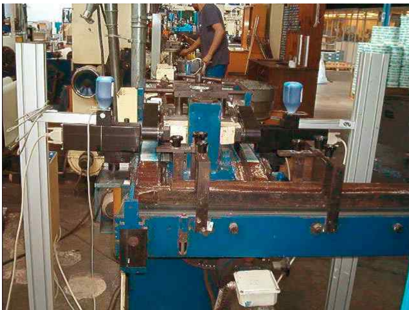
Tisková hlava ET7 s tiskem až 70 mm
